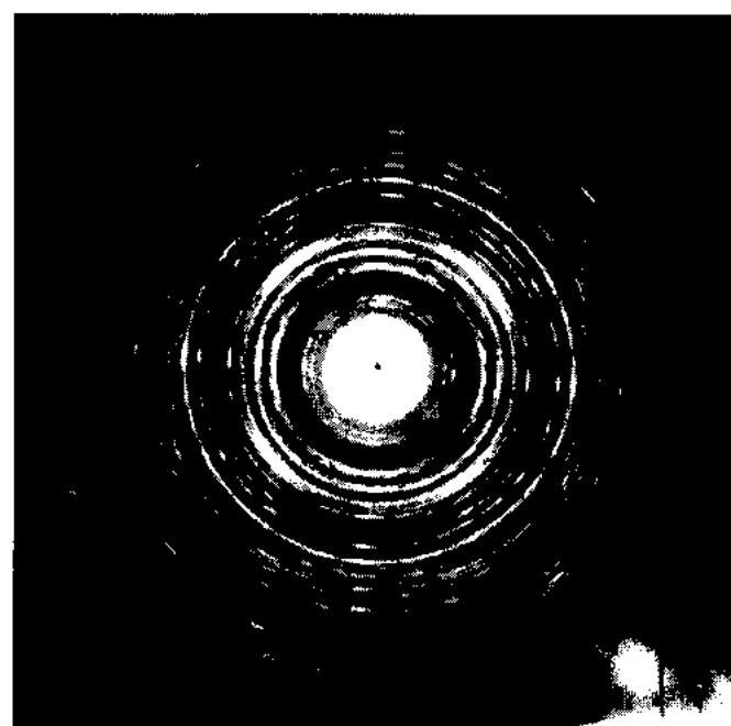
*Рис.1. Электронограмма пленки  $Sb_2S_3-Sb_2Se_3$ , осажденной на  $NaCl$  при температуре 350°C*
