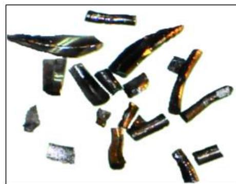
Şəkil 1.  $\text{Cu}_3\text{Fe}_{0.5}\text{Se}_2$  monokristallarının ümumi dörünüşü (böyüdülmüş 3 dəfə)
