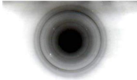
*Şəkil 1.  $Yb_{1-x}Sm_xAs_4S_7$  polikristal fazasından alınmış elektronogramma.*
